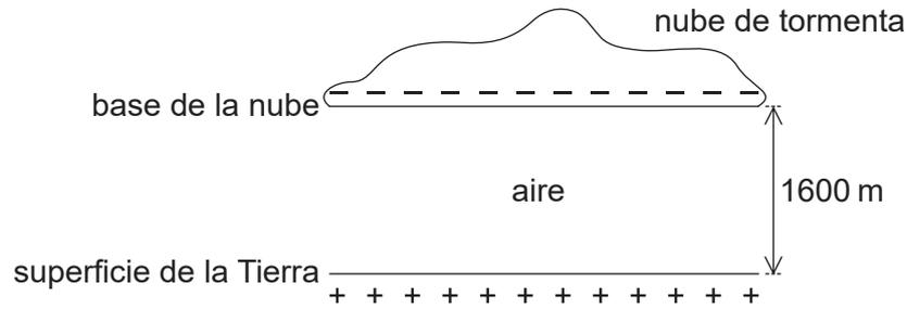
La placa inferior del capacitor es la superficie de la Tierra y la placa superior es la base de la nube.
